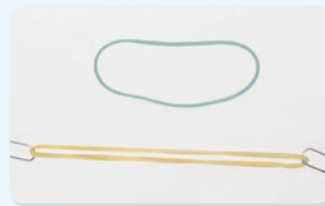
Figura 5.3 Tanto el módulo de elasticidad como el límite de elasticidad están determinados por la estructura molecular del material.
