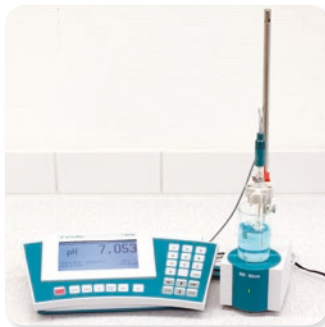
Figura 4.19 Medidor de pH (o pHmetro), que permite determinar la acidez o basicidad de una sustancia.
