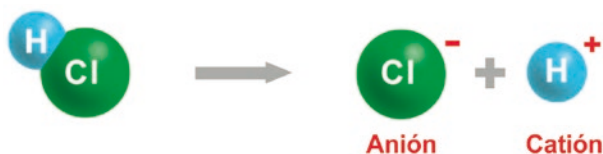
Figura 4.16 Representación esquemática de la separación en iones del ácido clorhídrico disuelto en agua.
