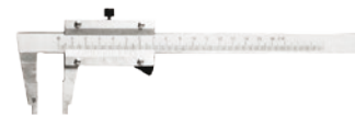
Fig. 1.14 El vernier tiene dos escalas, cerciérate de tomar la medida correcta usando ambas. Si tienes dudas, pregunta a tu profesor.
