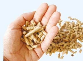
Figura 4.43 Pellets de desechos de madera comprimida que se emplean para producir calor.
